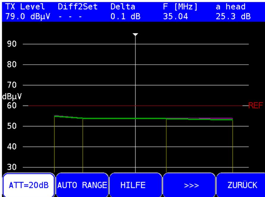
Am Linienverstärker den Rückkanal Dämpfungssteller solange drehen bis die grüne Kurve mit der lila Kurve näherungsweise Deckungsgleich ist
