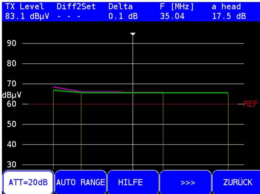
Am Hausverstärker am Rückkanal Dämpfungssteller solange drehen bis die grüne Kurve mit der lila Kurve näherungsweise Deckungsgleich ist
